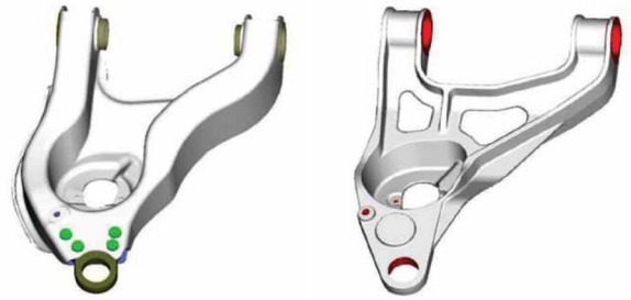
图 12 ADI 控制臂（右）替代冲压钢件（左） 减重 6%，性能测试超预期
