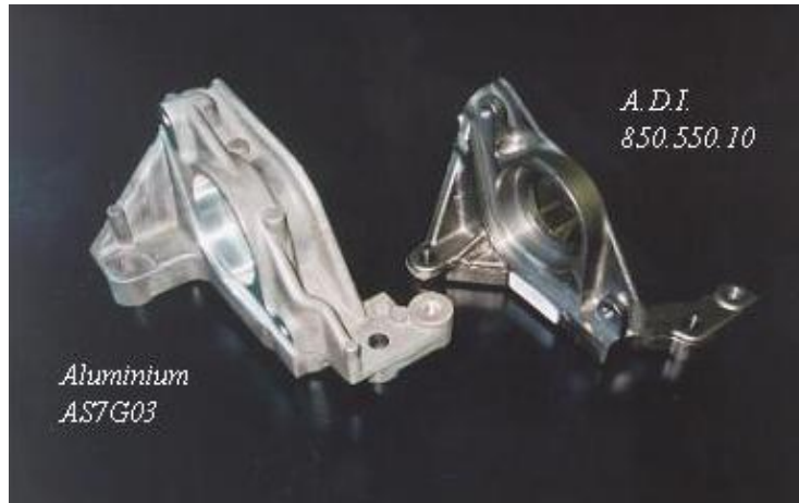
图 10 用 ADI 支架（右）替代了铝合金支架（左） 解决了一款车的舒适性（噪音小）问题
